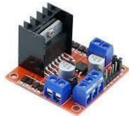
Fig. 3.4. L298N motor driver.
