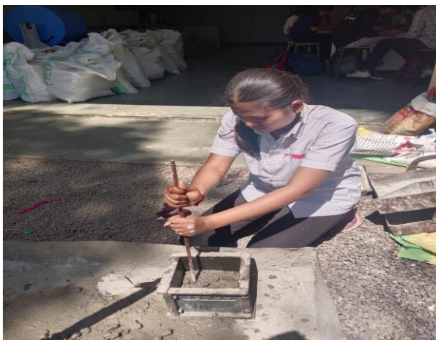
FIG.NO. 3.6. CASTING OF SPECIMENS
