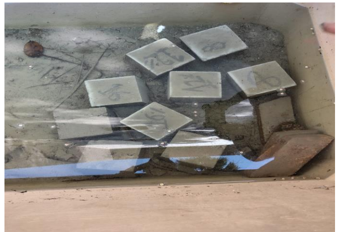
FIG.NO. 3.7. CURING OF CONCRETE
