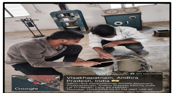
Fig:6 slump cone test
