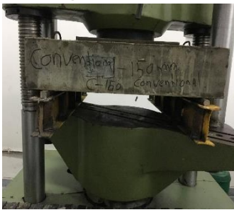
Fig.No. 5: conventional slab placed on UT
