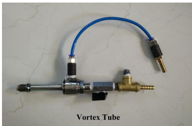
Fig-2: Actual vortex tube
