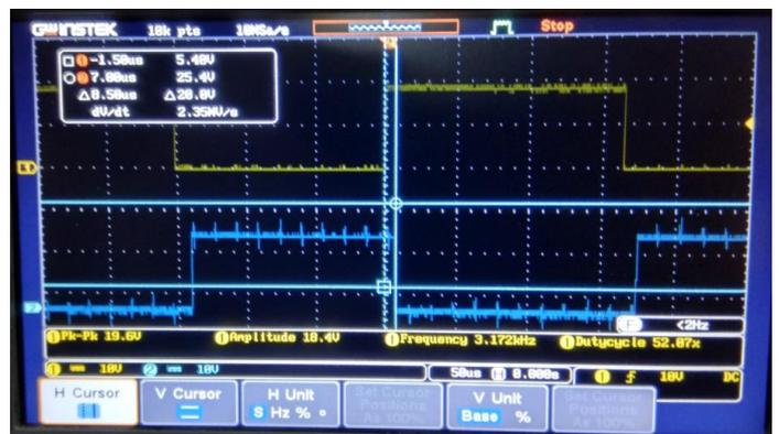
Figure 9 SIMPLE INVERTER GATE WAVEFORM
