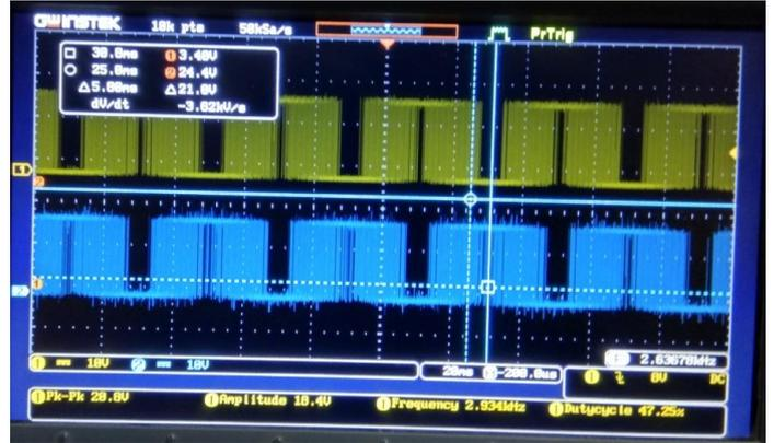
Figure 7 GATE PWM WAVEFORM
