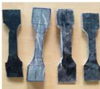
Fig. 2.1. Tensile test specimens.
