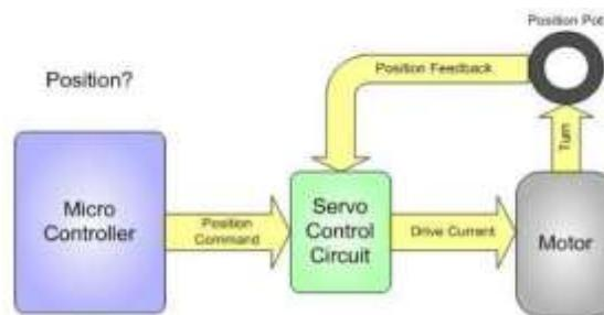
**Fig-servo motor controller**
