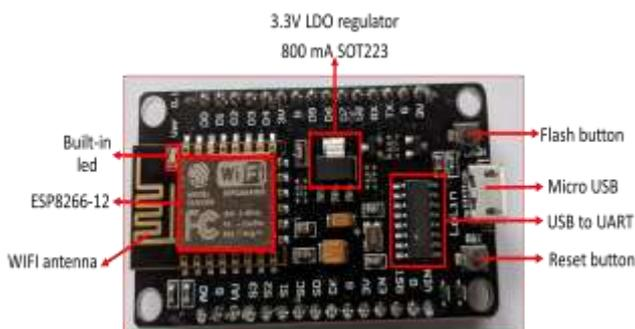
**Fig-1: ESP8266 Nodemcu**
