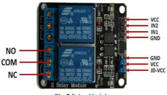
Fig-5 Relay Module
