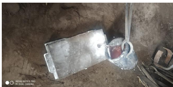
Fig: pouring the molten metal
