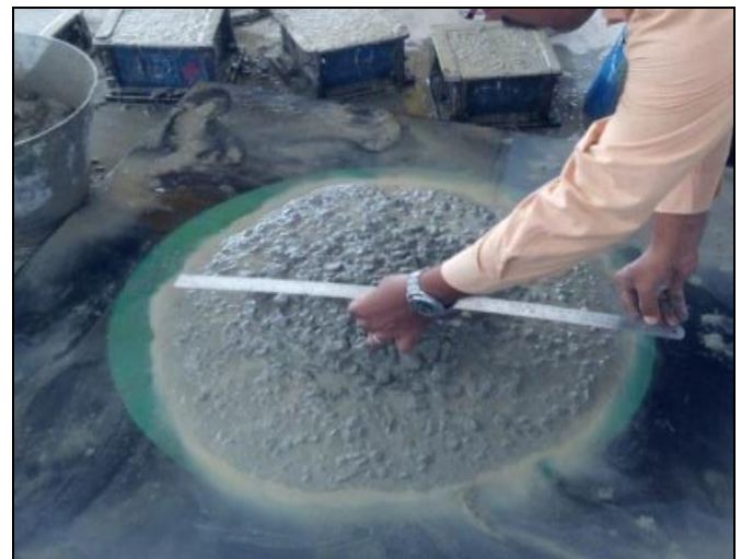
Fig -1: Slump cone Test
